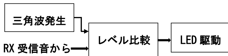
図 2 音声送信器のブロック図
