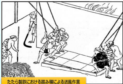
たたら製鉄における踏み鞆による送風作業 『日本山海名物図会』所載
